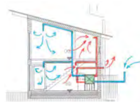
голубым выделен приток воздуха, красным - вывод OG – второй этаж EG – первый этаж
